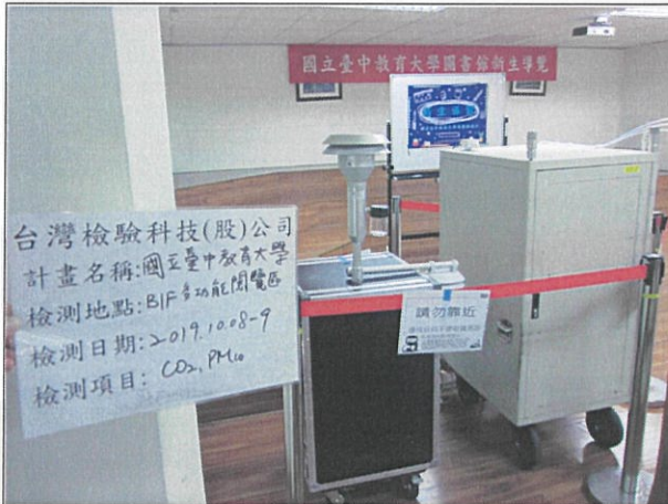
說明：室內空氣品質檢測(CO 2 、PM 10 ) 日期：2019/10/08~2019/10/09 地點：B1F 多功能閱覽區(#1)
